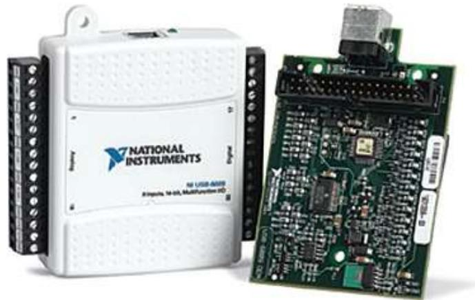
**Figura 43)** Tarjeta NI-USB 6008, Tomado de Nacional Instruments Inc. (c) 2007.
