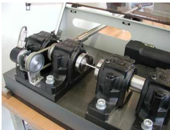
**Figura 12)** Maquina de ensayos de Fatiga por flexión rotativa, Tomada de Zwick Inc. (c) 2007.
