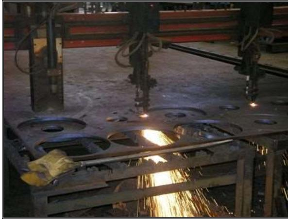
**Figura 1)** Corte con pantógrafo. Tomado de la Compañía General de Aceros, Inc. (c) 2007.
