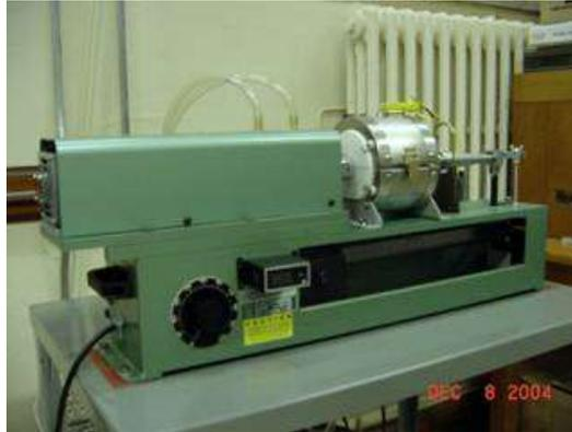
**Figura 13)** Maquina de ensayos de Fatiga por flexión rotativa, Tomada de Purdue University. (c) 2007.
