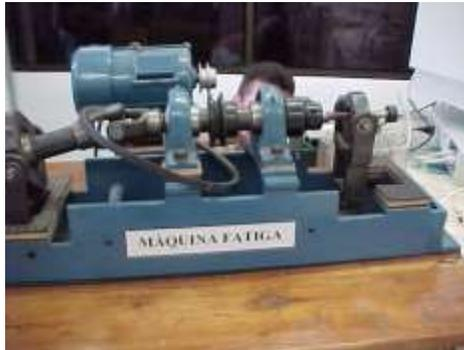
**Figura 15)** Maquina de ensayos de Fatiga por flexión rotativa, I.C.P.
