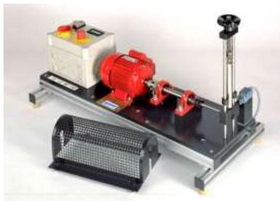
**Figura 14)** Maquina de ensayos de Fatiga por flexión rotativa, Tomada de G.U.N.T. Gerätebau Inc. (c) 2007.
