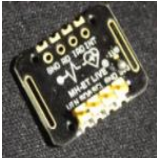
Figura 18. imagen del sensor para la toma de oximetría [autores].
