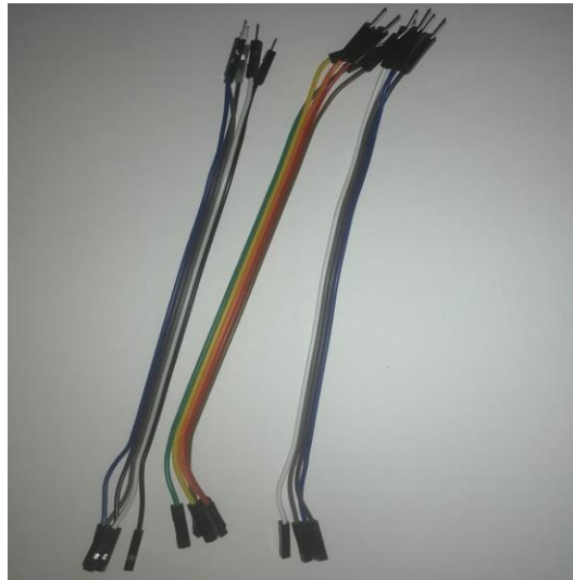
Figura 14. imagen de los cables de conexión del sistema [autores]
