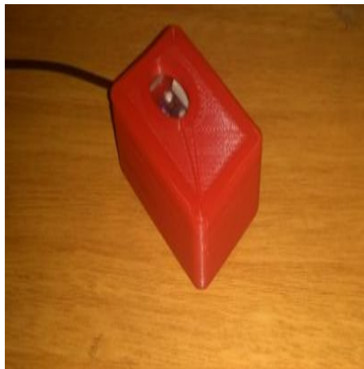
Figura 35. Fotografía del sensor MAX 30102 finalizado (saturación de oxígeno y frecuencia cardíaca) [autores]
