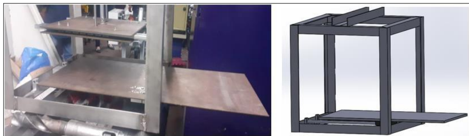
Figura 34. Sistema de rieles. Autores.
