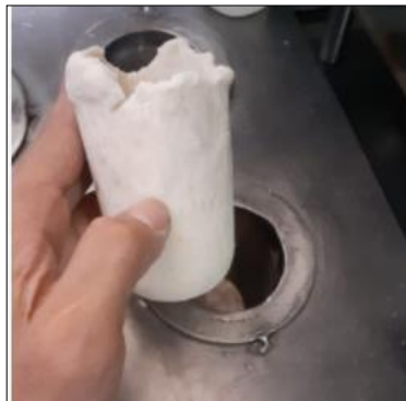
Figura 55. Canastas fabricadas para la prueba de presiones. Autores.
