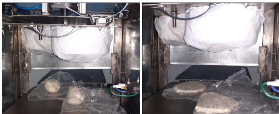
Figura 62. Proceso de embutido con la mejora para patacones planos. Autores.
