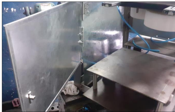
Figura 38. Puerta superior de seguridad. Autores.
