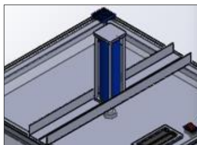
Figura 22. Acoplamiento de actuador en la estructura base del sistema. Autores.
