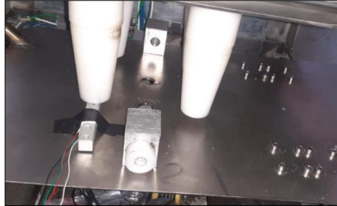
Figura 54. Adaptación de la celda de carga en el sistema de embutido. Autores.
