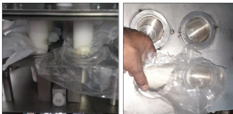
Figura 63. Proceso de embutido con la mejora para canastas de patacón. Autores.
