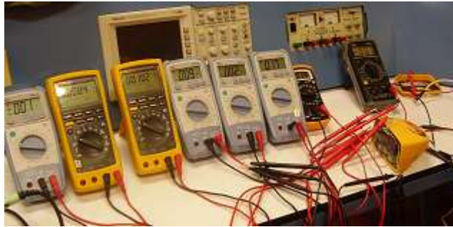
Figura No. 65: Practica realizada de la toma de voltajes
