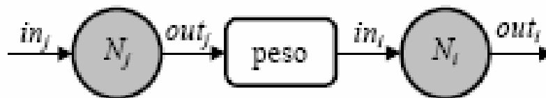
Figura 14. Influencia de la salida de la neurona N_j en la entrada de la neurona N_i .
