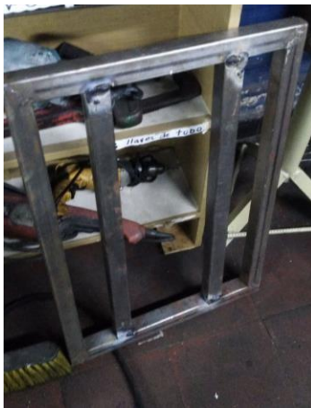
Ilustración 94. Soporte base tolva.
