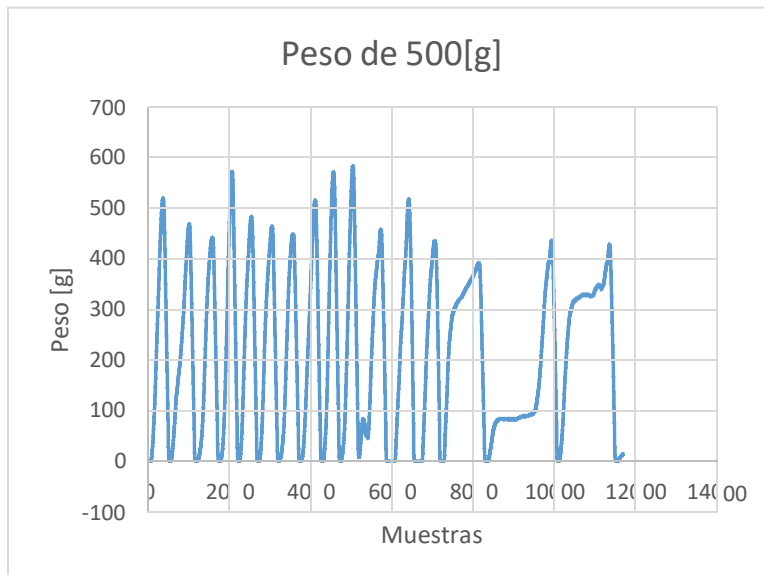
Ilustración 114. Muestras del sensado del peso del producto con un nivel mínimo de mora en la tolva.
