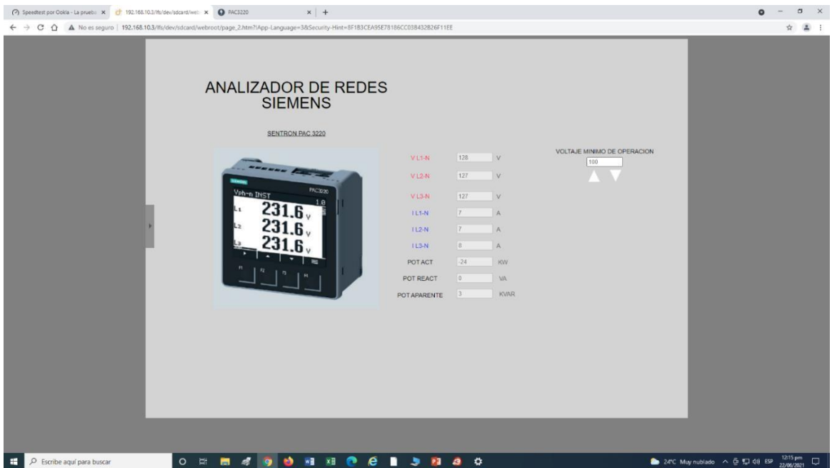
Figura 92. Página del analizador de redes donde se aprecian las lecturas de voltaje, corriente y potencia en tiempo real. Y dentro de la misma un enlace a la dirección IP propia del analizador FUENTE: Autor.
