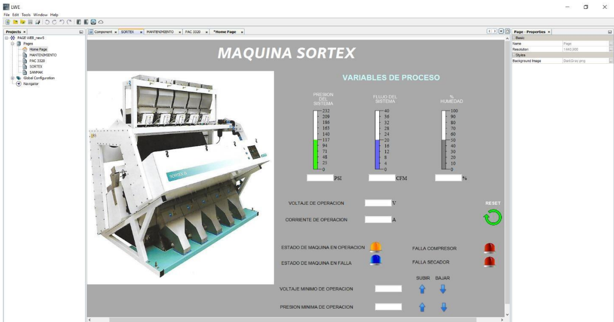
Figura 34. Página de monitoreo de la máquina electrónica SORTEX. FUENTE: Autor.
