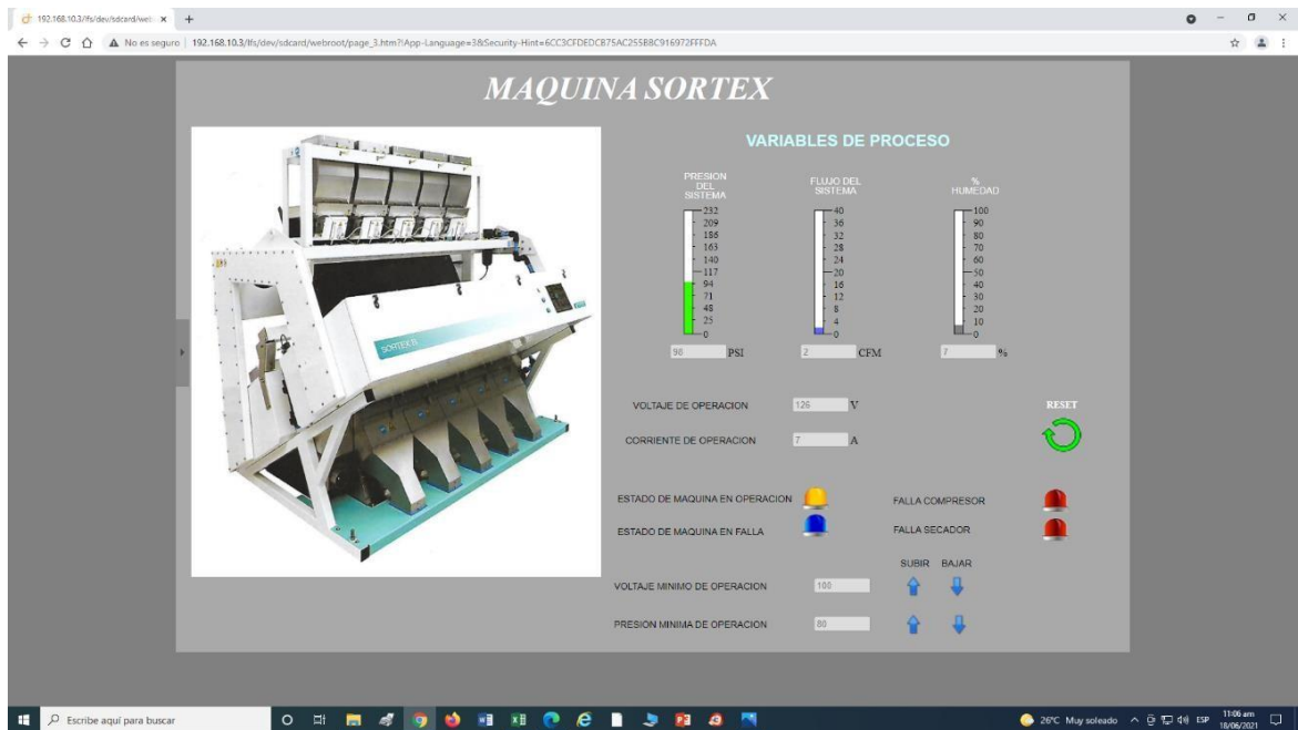
Figura 90. Página de monitoreo de la máquina SORTEX, donde se puede visualizar las variables del proceso en tiempo real, así como los estados de operación de la máquina FUENTE: Autor.
