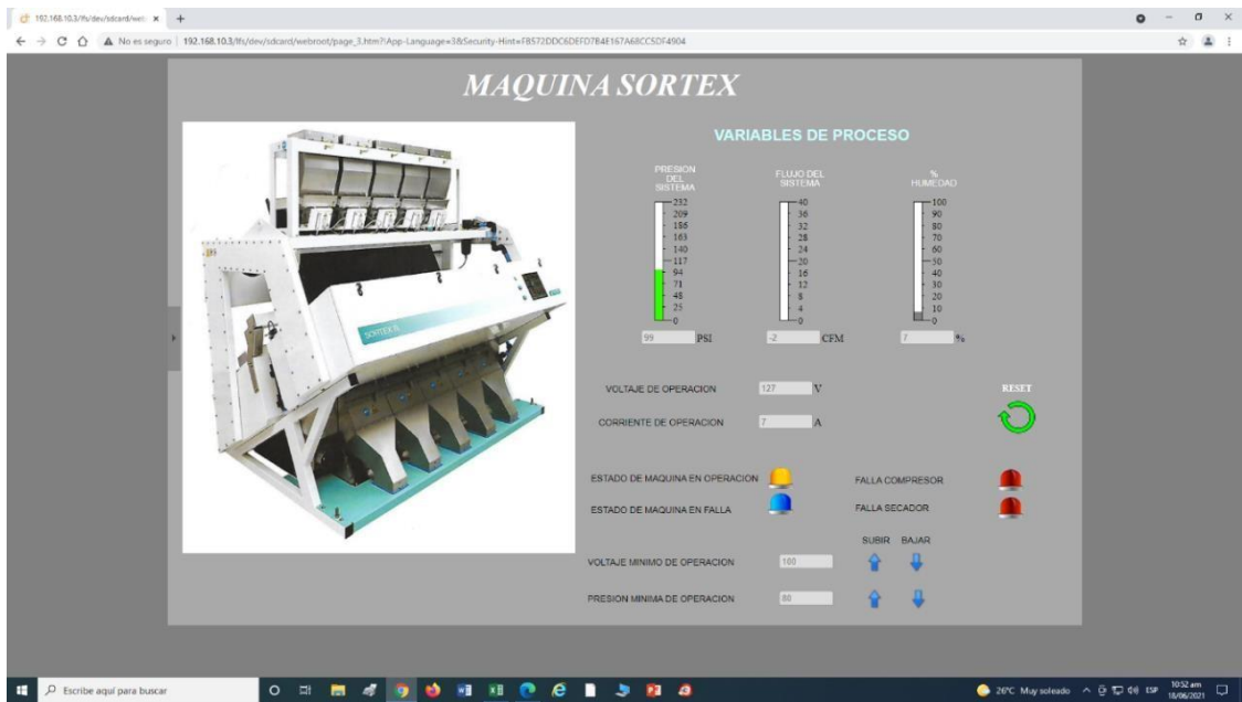
Figura 44. Verificación LED de falla de la máquina SORTEX en la página WEB que indica que la máquina está detenida y el sistema de alarmas encendido. FUENTE: Autor.
