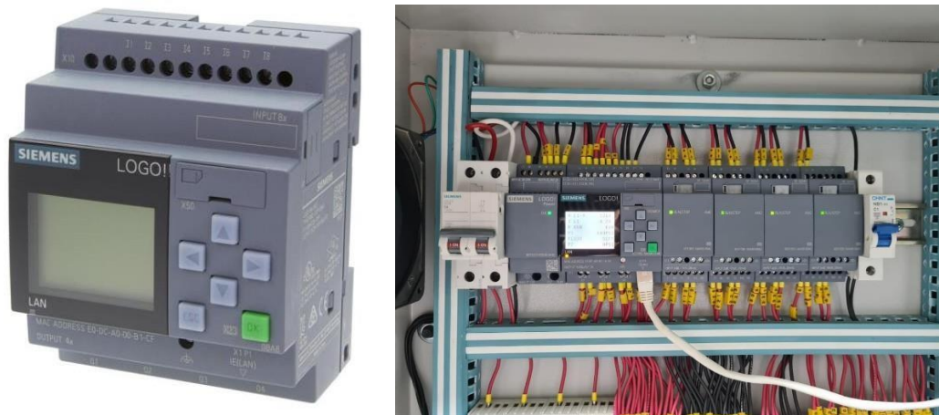
Figura 18. CPU Siemens LOGO! 12/24RCE con display - 6ED1052-1MD08-0BA0 FUENTE: Vía Industrial.
