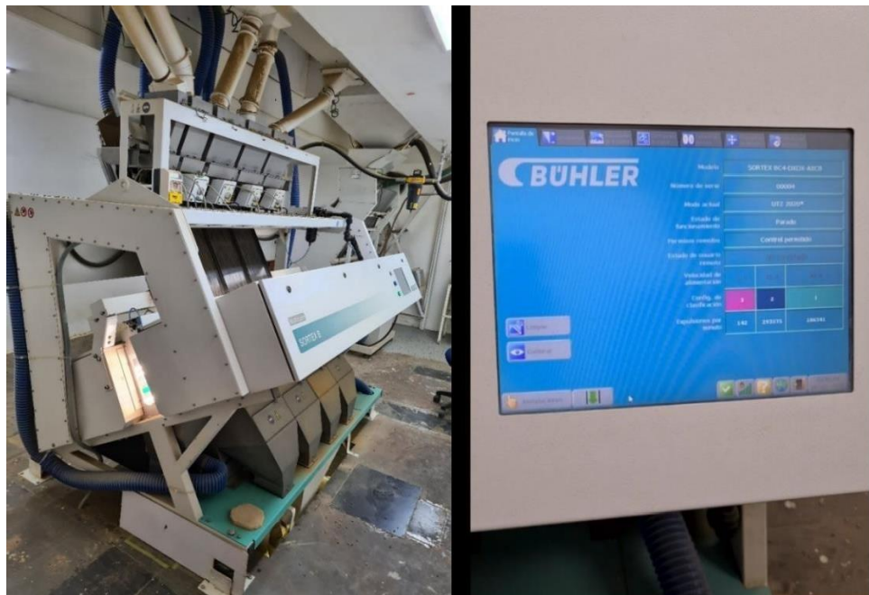
Figura 2. Máquina electrónica escogedora Bühler AG SORTEX B4 de 4 bandejas y su respectiva HMI FUENTE: Trilladora Coopecafenor
