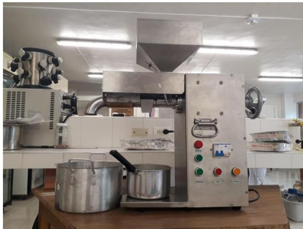
**Figura 16.** Prensa usada para la extracción del aceite CINBBYA
