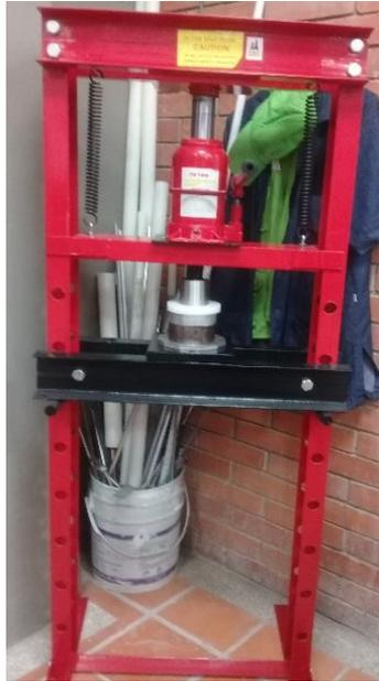
**Figura 32.** Gato Hidráulico usado para prensar el residuo
