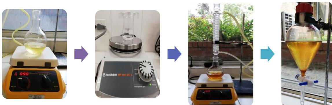
**Figura 20.** Proceso de producción del biodiesel por vía química
