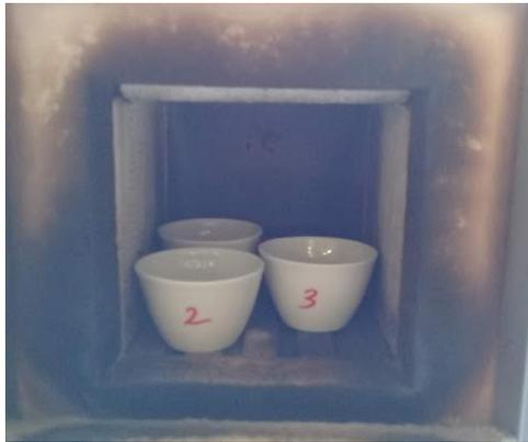
**Figura 38.** Fotografía de crisoles en la mufla a 550°C
