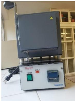
**Figura 34.** Mufla usada para la prueba de cenizas
