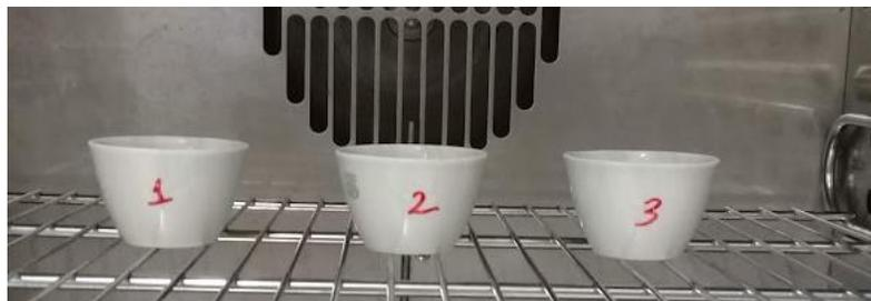
**Figura 37.** Fotografía de crisoles en el horno a 105°C
