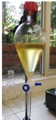
**Figura 22.** Proceso de lavado del biodiesel
