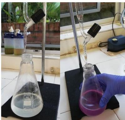
**Figura 23.** Prueba de índice de acidez para el biodiesel
