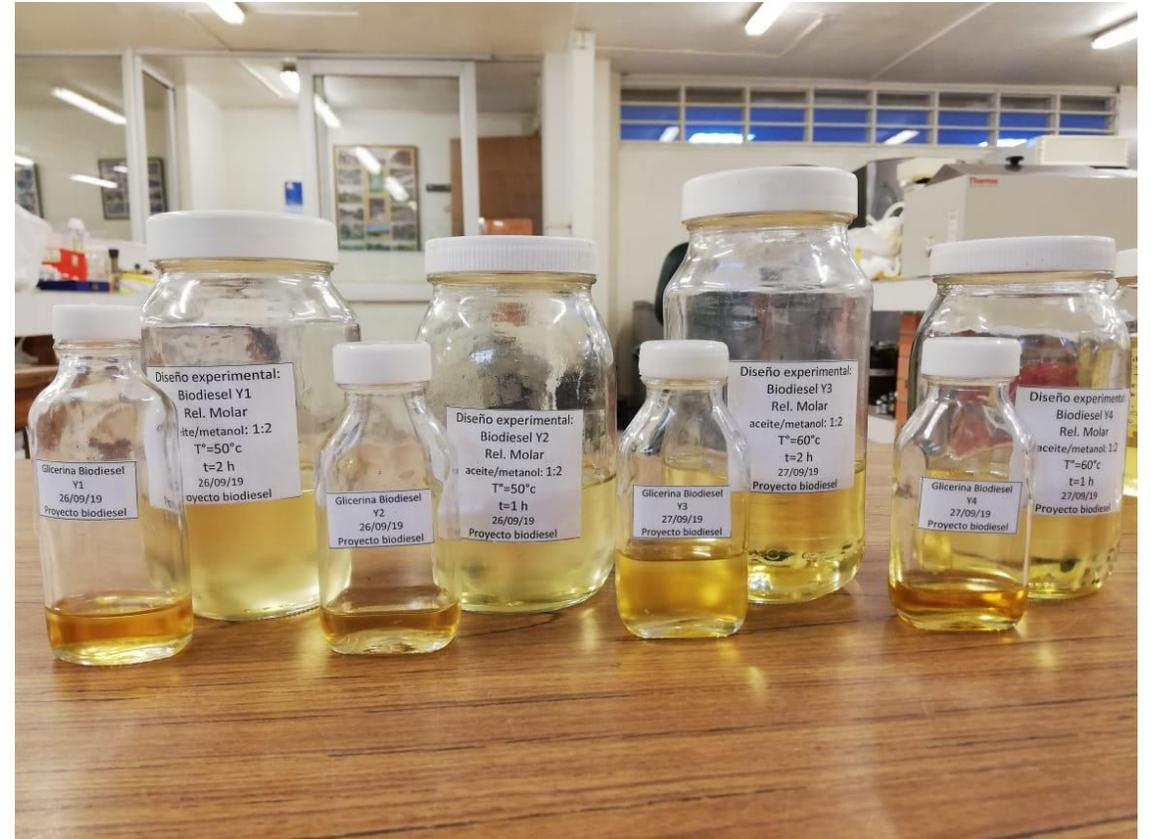
*Resultados del diseño experimental del proceso de transesterificación por método químico*
