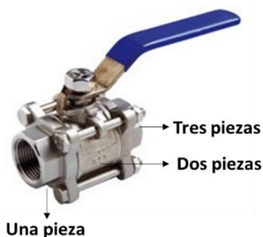
Ilustración 13: Válvula de bola de tres piezas
