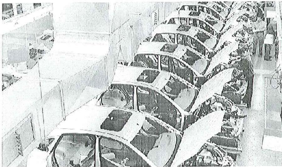
Las carrocerías llegan ordenadas desde la Planta de Pinturas por un túnel. Una vez han descendido, se desmontan las puertas, las cuales siguen una línea diferente donde se acondicionan, colocándoles guías, cristales, paneles laterales, elevallunas manual o automático, ... . Después, estas puertas se colocarán en otra línea diferente y en el mismo coche del cual habían sido extraídas ...
