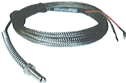
La termocupla Tipo J, conocida como la termocupla hierro – constantán. El hierro es el conductor positivo, mientras que para el conductor negativo se recurre a una aleación de 55 % de cobre y 45 % de níquel (constantán). El rango de Temperatura de la termocupla es de -200 a 900 Grados Celsius.
