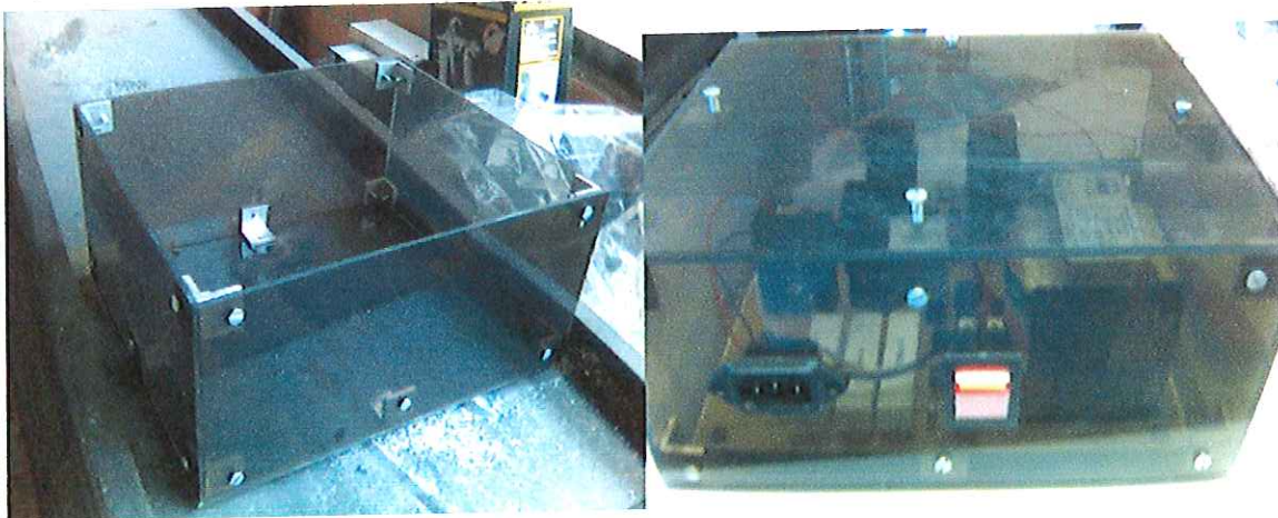
Figura 56. Fuente alimentación y circuito de control de giro en caja de acrílico
