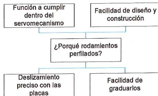
Figura 25 Criterio de selección de los rodamientos perfilados
