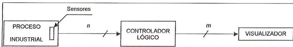
Figura 31. Sistema de control en lazo abierto.
