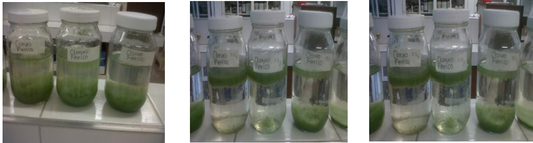
Figura 14. Método de recolección de microalgas con adición de floculante
