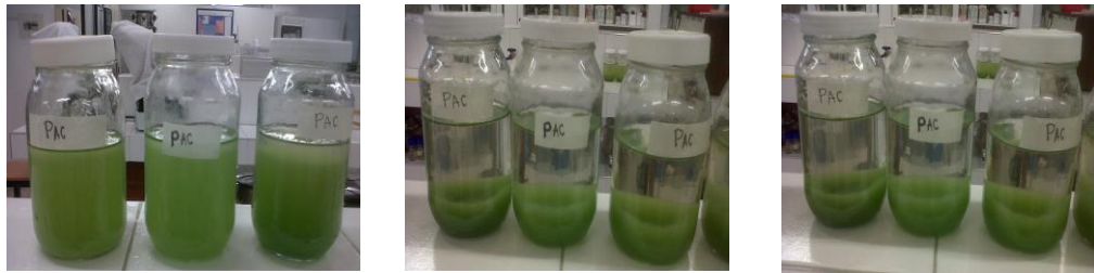
Figura 12. Método de recolección de microalgas con adición de floculante
