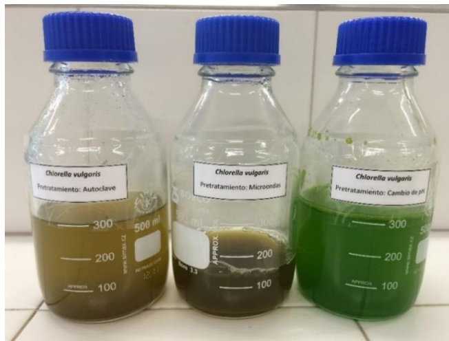
Figura 19. Cultivo de microalga Chlorella vulgaris sometido a procesos de pretratamiento, autoclave, microondas, cambio de pH.
