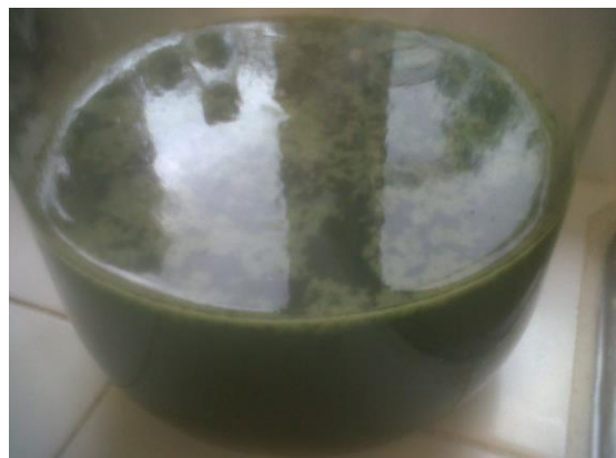
Figura 10. Recolección de biomasa mediante sedimentación por gravedad
