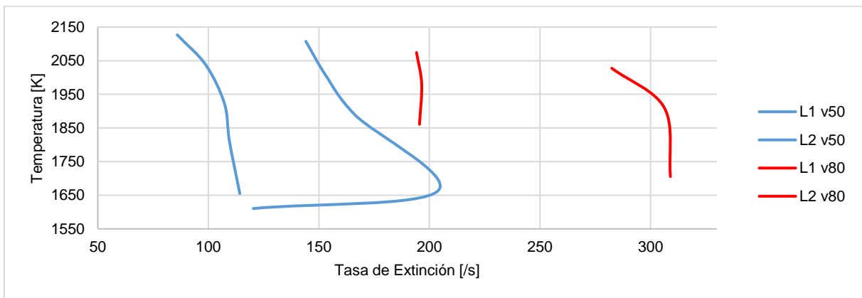
Figura 117. Comparación entre las zonas de intercambiabilidad a partir de los límites de extinción del GN La Guajira a velocidades de entrada de 50 y 80 cm/s
