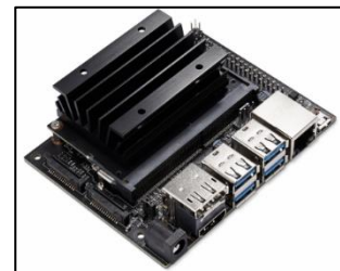
Figura 33. NVidia Jetson Nano.
