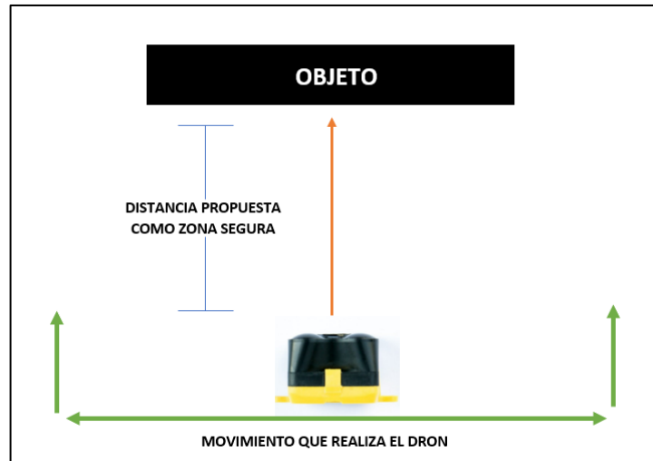
Figura 50. Función del sensor TeraRanger en el proyecto [25].
