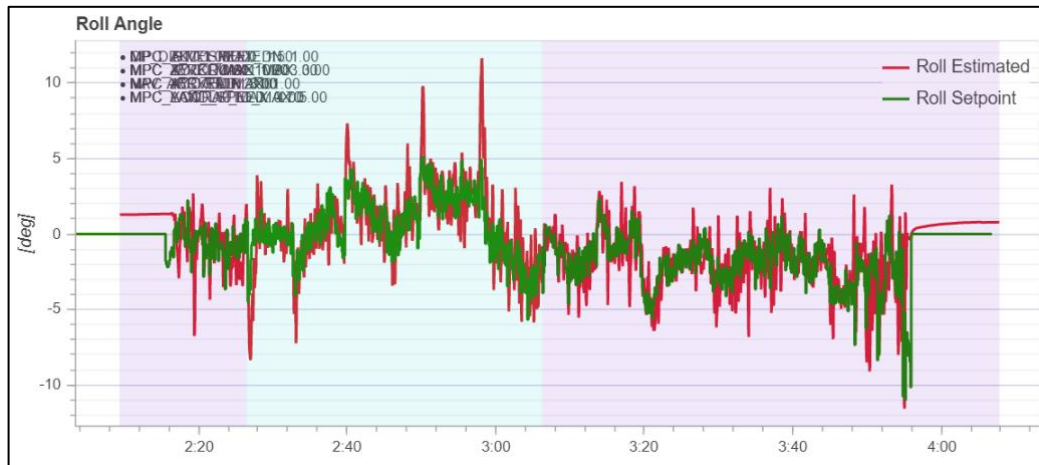
Figura 58. Datos de ángulo (TCE, grados) de la prueba “4 puntos” con respecto al eje de aviación Roll [25].
