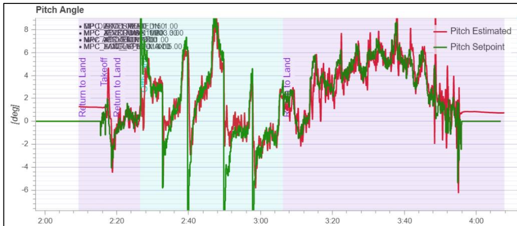
Figura 59. Datos de ángulo (TCE, grados) de la prueba “4 puntos” con respecto al eje de aviación Pitch [25].
