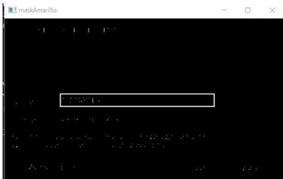
Figura 34 Imagen binaria obtenida después de aplicar detección de color amarillo.
