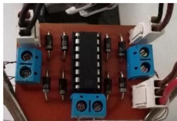
Figura 26. Vista superior de circuito de puente H. Fuente: Autor
