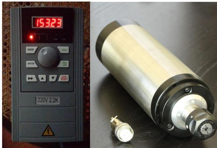
*Figura 18. Variador de frecuencia y spindles. Fuente: Autor*
