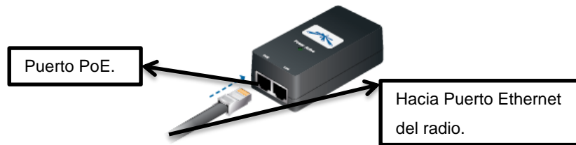
Figura 19. Conexión de radio y adaptador PoE. [12]
