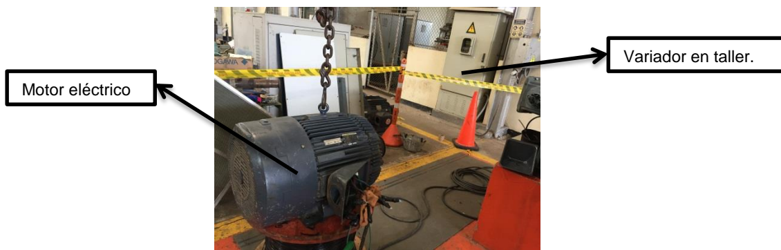
Figura 14. Prueba de motor eléctrico de 75HP en taller. [Autor].
