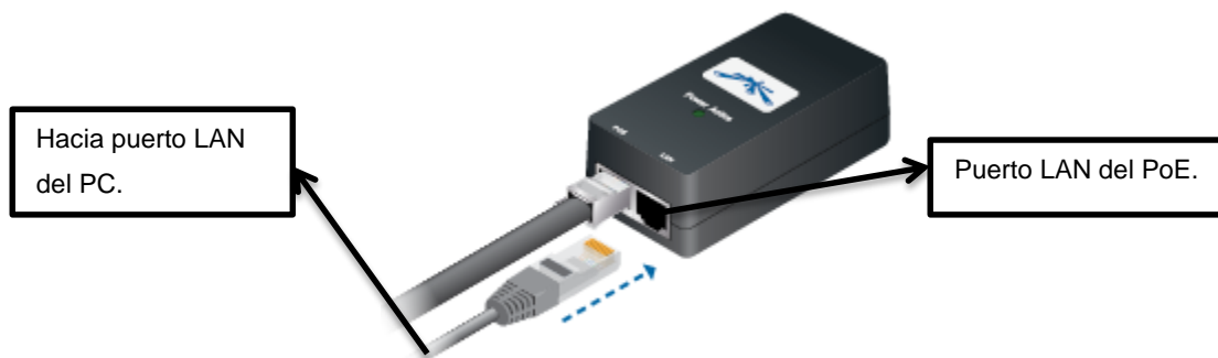
Figura 20. Conexión de adaptador PoE y computador. [12].
