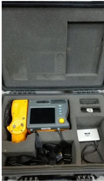
Figura 24. Cámara de termografía taller eléctrico. [Autor].
