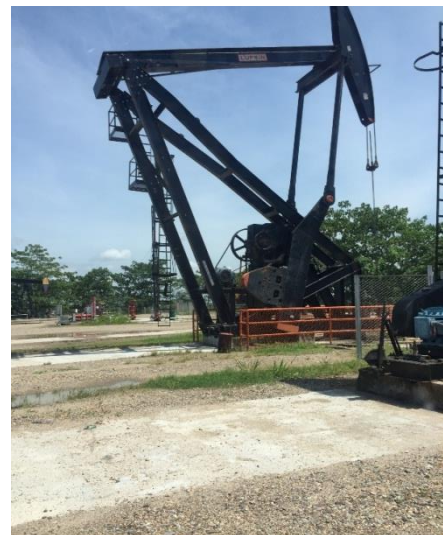
Figura 9. Funcionamiento Unidad de bombeo mecánico. [9]. Y Unidad de bombeo mecánico en Casabe sur. [Autor].
