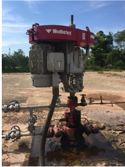
Figura 11. Elementos de superficie PCP. [9]. Y pozo PCP en Casabe. [Autor].
