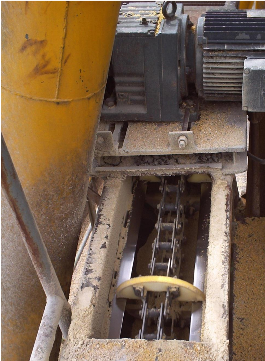
Figura 8. Mecanismo transportador de arrastre
