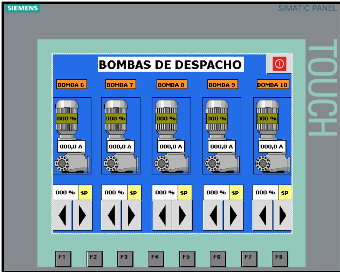
Ilustración 5. Selección de bombas modo automático
