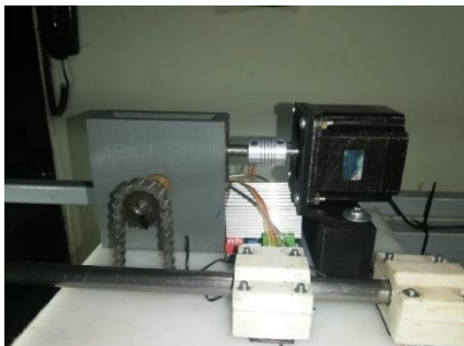
Figura 97. Ensamble del sistema de transmisión en Y tomado de autor
