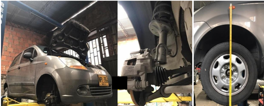
Figura 18. Análisis de la suspensión del SPARK.
