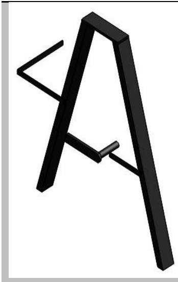
Punto de apoyo del conjunto de suspensión. Medidas: 11 x 12 cm Material: Hierro
