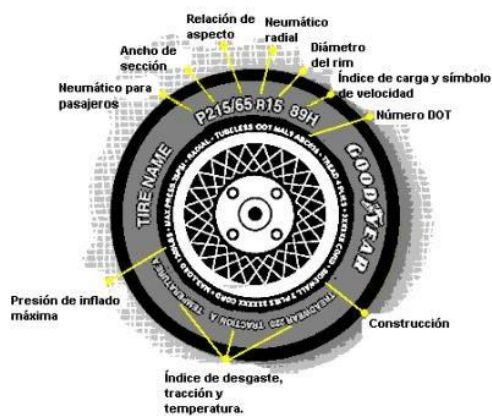
Figura 7. Nomenclatura del neumático.
