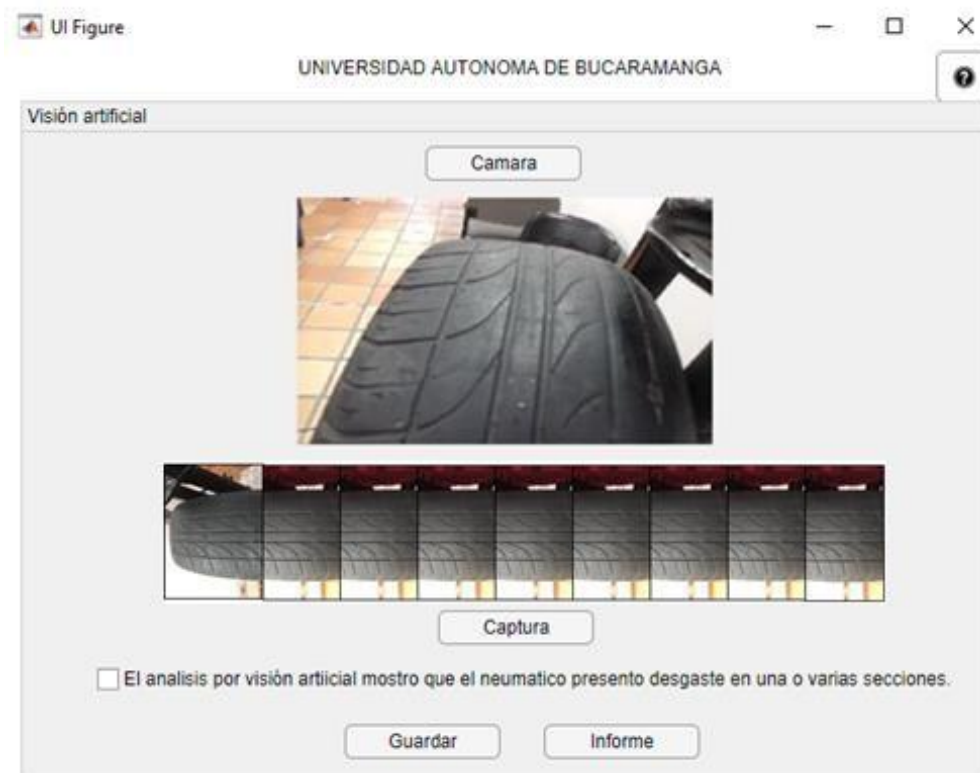
Figura 79. Vista de la interfaz con todas las imágenes tomadas para ver la banda de rodamiento completa.
