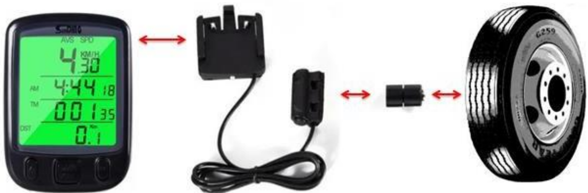
Figura 14. Conexión del sensor SunDing en el neumático (Manualscat, 2021)
