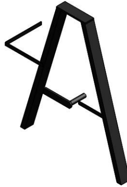
Figura 43. Soporte del conjunto de suspensión diseñado en Solidworks.
