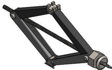
Figura 38. Elevador mecánico diseñado en Solidworks.
