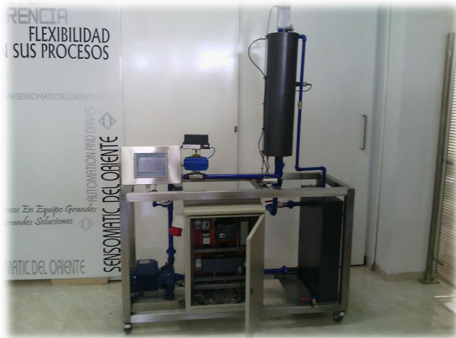
Figura 16 Banco de nivel finalizado .
