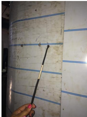
Figura 7-13. Ubicación del segundo sensor de pH en la parte superior del tanque fermentador.
