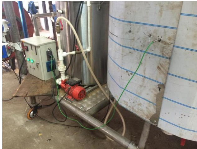
Figura 7-22. Conexión del sensor de temperatura del controlador al tanque fermentador para monitoreo y accionamiento del chiller.
