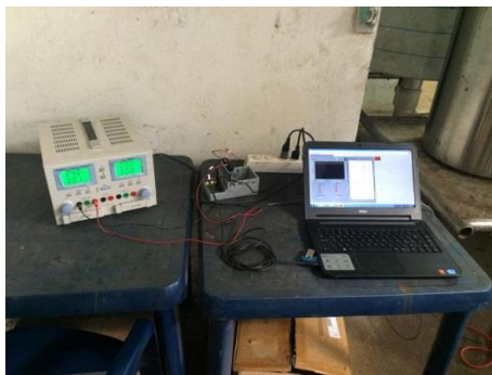
Figura 7-17. Conexión del módulo universal, el computador y la fuente reguladora de voltaje.
