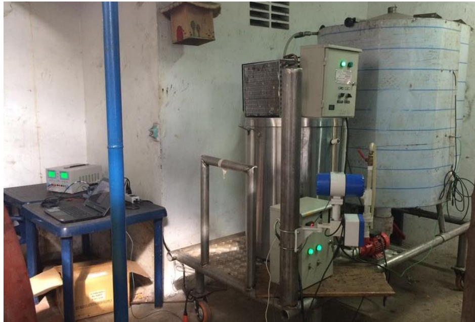
Figura 7-28. sistema general de adquisición y control de temperatura y pH para fermentación de café.
