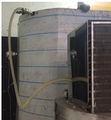
Figura 7-4. Manguera conectada entre el tanque fermentador y el Chiller para que recircule desde el tanque hasta el chiller.
