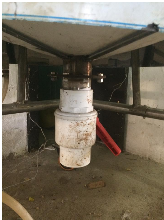
Figura 7-9. Sistema de evacuación del mucílago de café del tanque fermentador ubicado en la parte inferior central del mismo.
