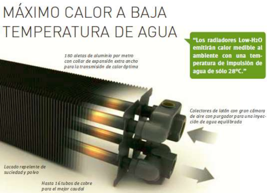
Figura 3.1 Componentes del radiador Jagga.
