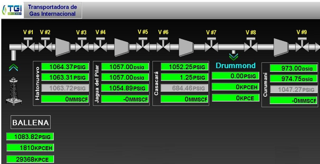
Figura 9: Detalle de condiciones de presión y flujo para un tramo de tubería. Software OpenEnterprise en Modo Runtime (transmisión en tiempo real)
