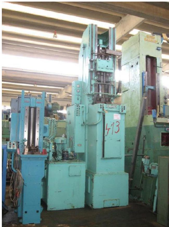
**Figura 9:** Brochadora Varinelli (modelo utilizado para el brochado de trípode y companion en la compañía).
