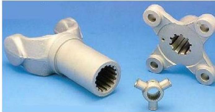
**Figura 8:** Ejemplo de pieza con brochado interior.
