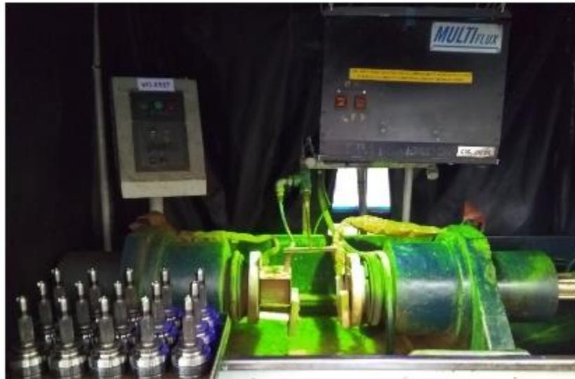
**Figura 4:** Máquina de inspección de grietas por partículas magnéticas.
