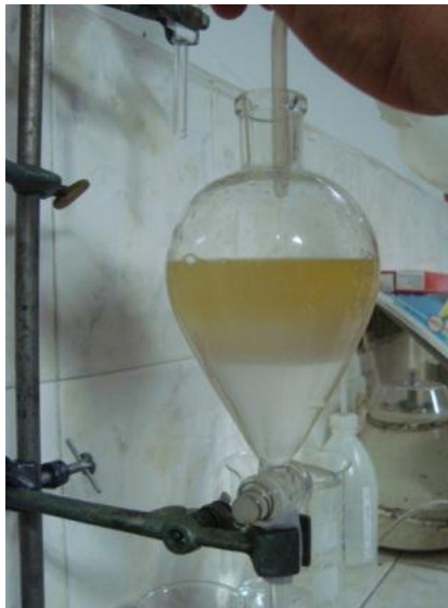
Imagen 2. Lavado del biodiesel crudo con agua destilada
