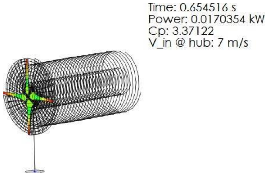
Ilustración 29. Simulación Q-blade de la turbina de 4 álabes Fuente propia
