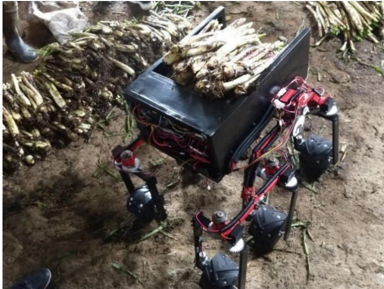
Ilustración 142 Vehículo en modo transporte con carga en terreno – A.
