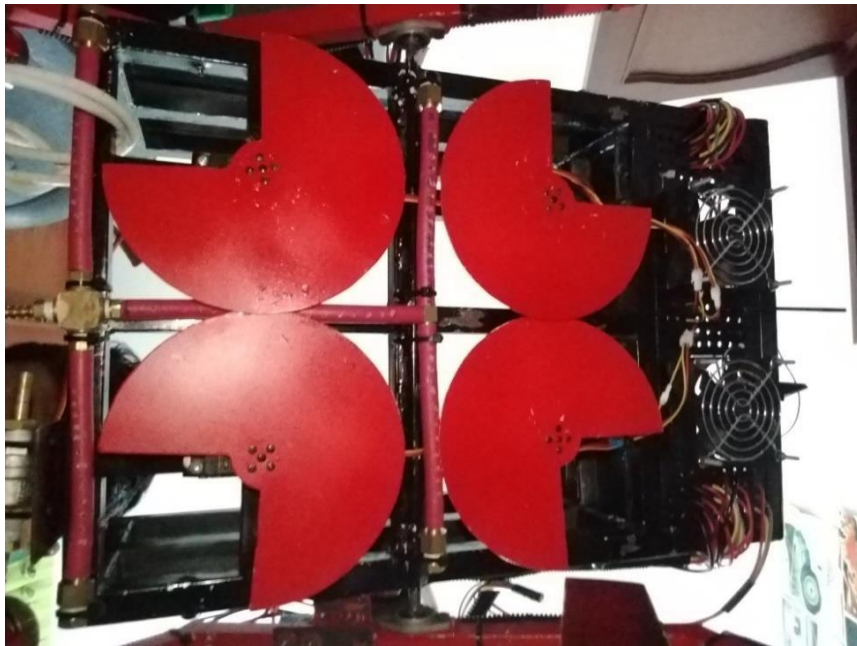
Ilustración 151 Mangueras del sistema de riego.
