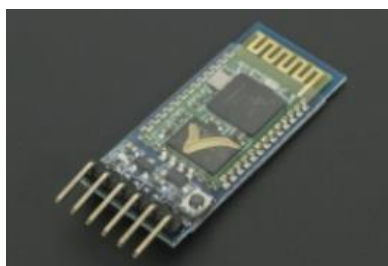
Ilustración 114 Módulo bluetooth HC-05.
