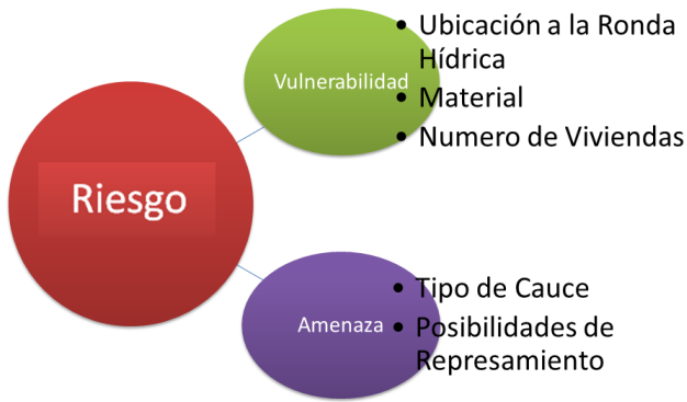
Cuadro 11. Sistemas de Inferencia con sus respectivas variables para la estimación del Riesgo de Inundación
