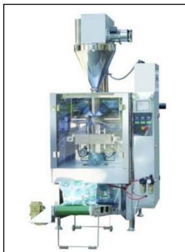
Imagen 5. Máquina empacadora de caramelo en polvo (Delani, 2019)
