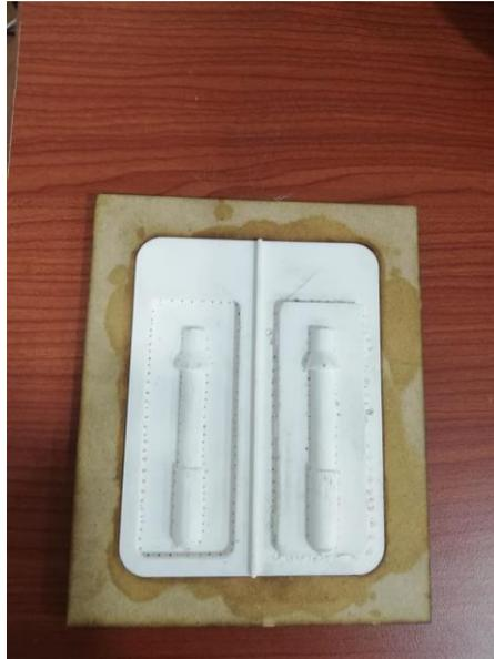
*Figura 11.* Pieza realizada en impresora 3D para pruebas de termoformado
