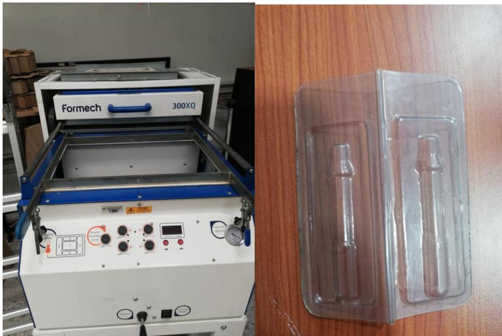
Figura 10. Piezas realizadas en la termoformadora
