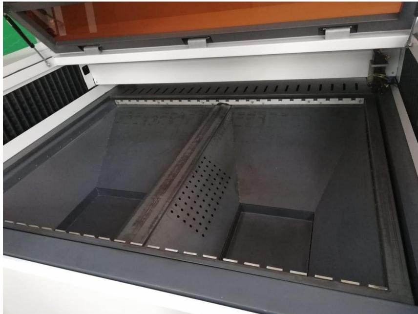
*Figura 13.* Limpieza de los compartimientos para el residuo de material.
