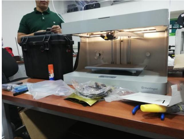
Figura 20. Impresora con materiales compuestos
