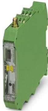
Radioline: transceptor de radio de 2,4 GHz con interfaz RS-232/485, ampliable con módulos de E/S, conexión de antena RSMA (hembra), redes punto a punto, en estrella y enmalladas hasta 250 estaciones, alcance hasta 5 km (con buena visibilidad).
