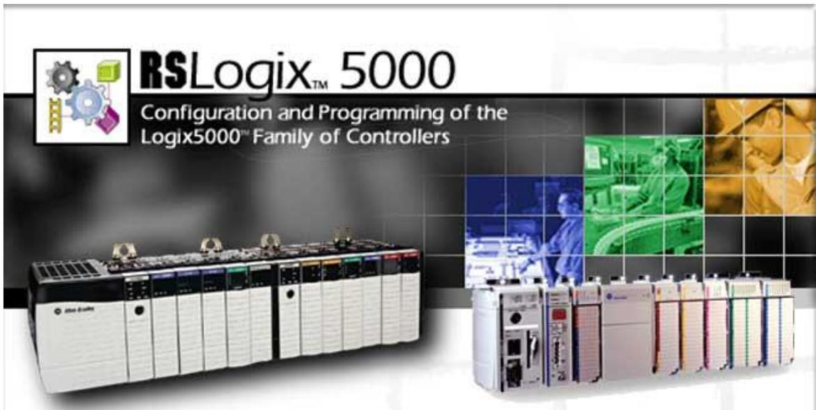
El software RSLogix 5000 está diseñado para programar controladores de la familia Logix 5000 y para la plataforma logix de Rockwell Automation. Utiliza varios tipos de lenguaje de programación como Escalera (Ladder), Bloques de funciones (Functions blocks), texto estructurado (structured text) y esquemas de funciones secuenciales (Sequential Function Chart).
