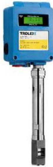
Este sensor cumple todos los requerimientos, ya que el sistema de medida es por dispersión térmica, por lo que no tiene partes móviles. El rango de medida está entre 0,5 - 30m, con una señal de salida de 4 – 20mA, además cuenta con certificación ATEX para atmosferas explosivas, ver cotización en el ANEXO B.
