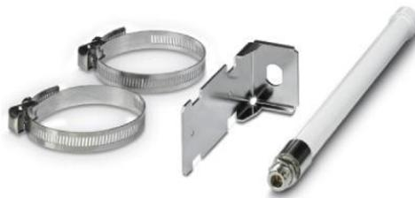
Antena omnidireccional, 2,4 GHz, ganancia: 6 dBi, polarización: lineal, ángulo de apertura: h/v 360°/30°, índice de protección: IP67, resistente al agua de mar, conexión: N (hembra), incl. soporte de montaje y abrazaderas de mástil, homologación ATEX e IECEx.
