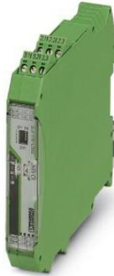
El módulo de extensión RAD-AI4-IFS I/O se puede usar en conjunto con módulos inalámbricos Radioline y otros dispositivos maestros del Sistema de Interfaz (IFS). En una estructura de estación, se pueden conectar hasta 32 módulos de extensión de I/O a un módulo inalámbrico a través del conector del riel DIN.
