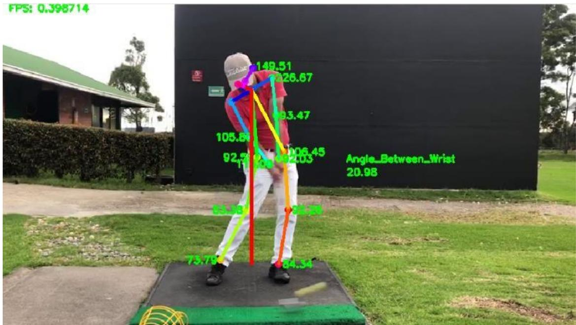
Ilustración 11 Resultado del algoritmo realizando el análisis etapa impact swing.
