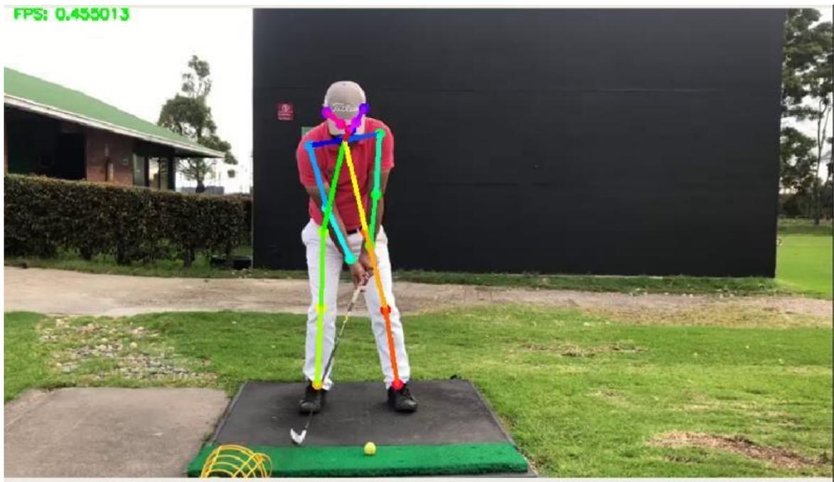
Ilustración 6 Resultado del algoritmo detectando la silueta del jugador en la posición inicial.
