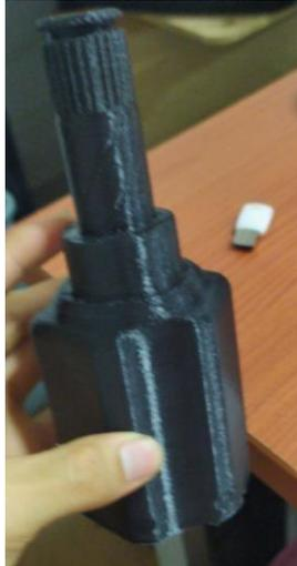
**Figura 31.** Impresión 3D en formato fibra de carbono [36].
