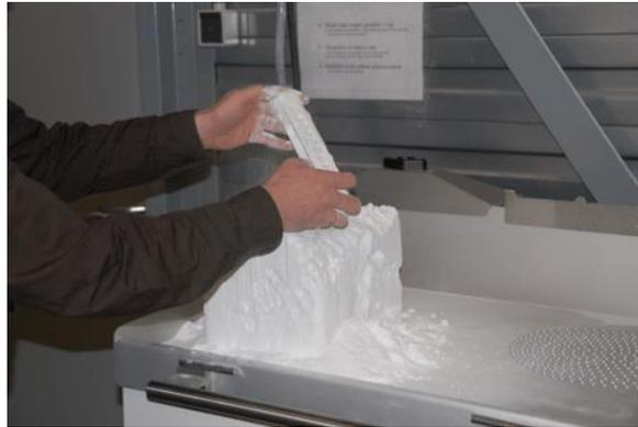
Figura 13. Impresión 3D de sinterización selectiva por láser [20].
