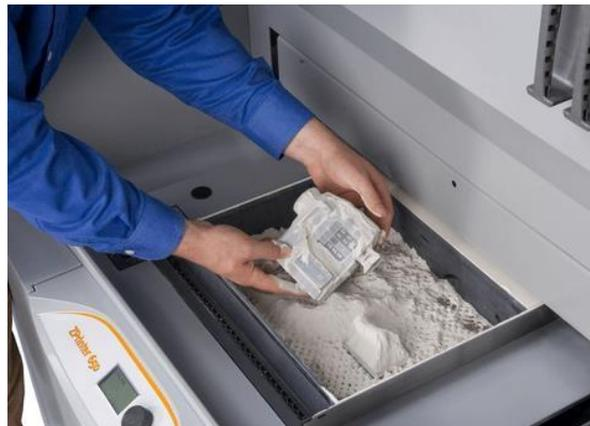
Figura 14. Impresión 3D por inyección [20].
