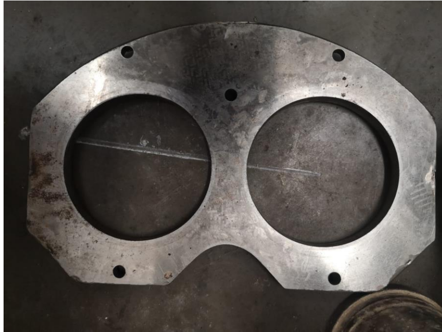
Figura 104 Placa gafa CIFA Fuente: Tomada por el autor.
