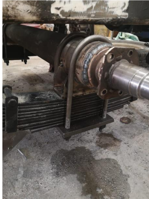
Figura 49 Instalación de la bridas Fuente: Tomada por el autor.
