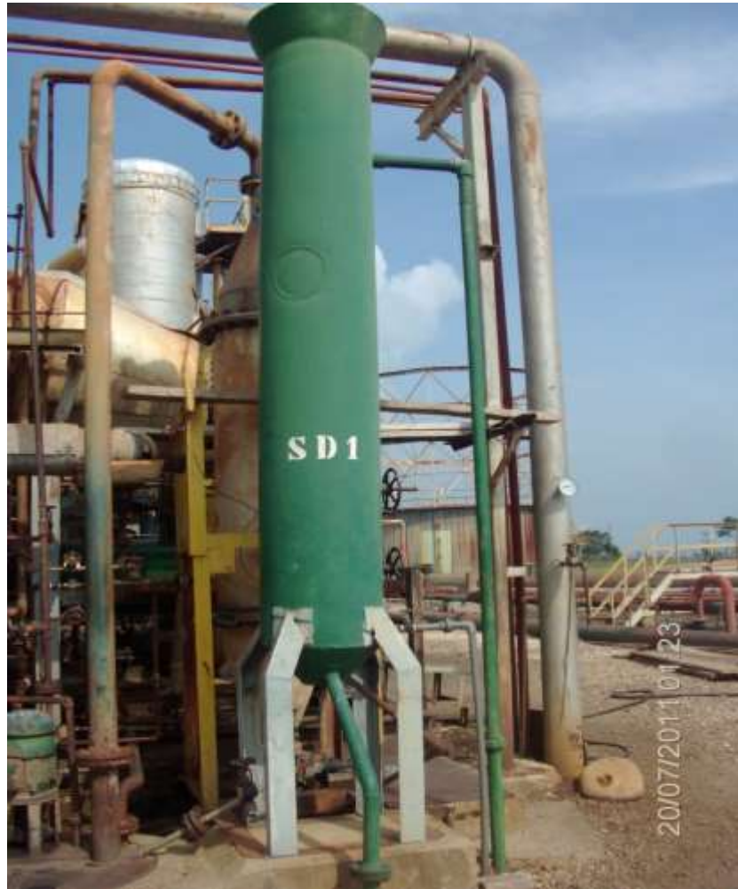
Imagen 24. Separador primario de amoniaco.
