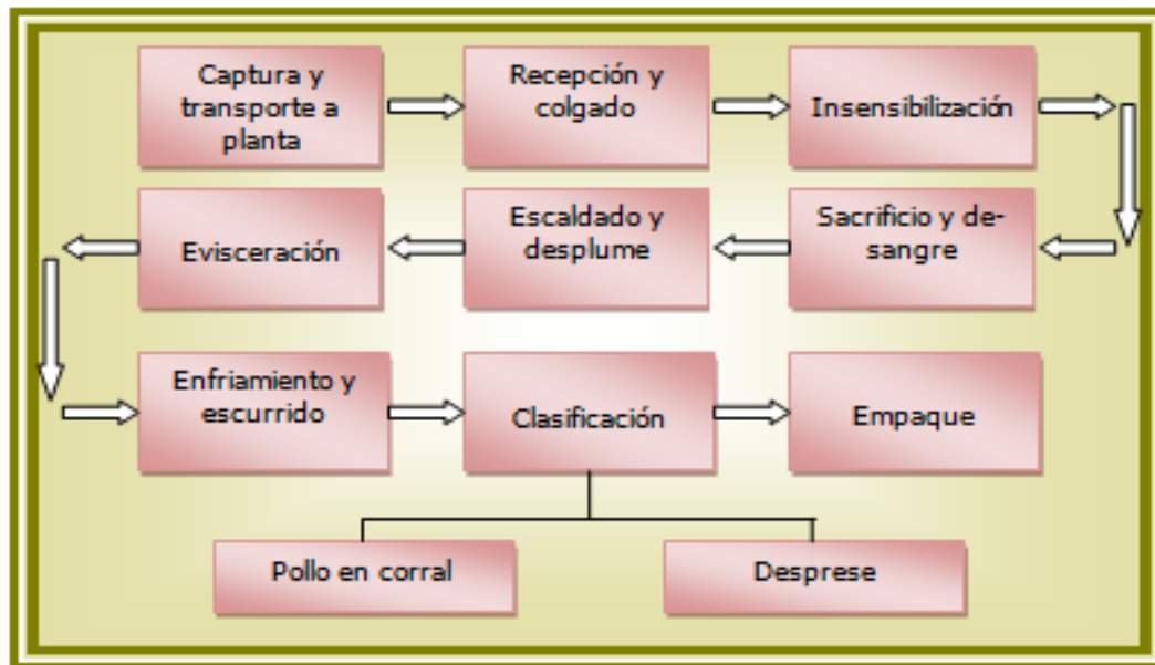
Figura 3. Diagrama de proceso de beneficio de aves
