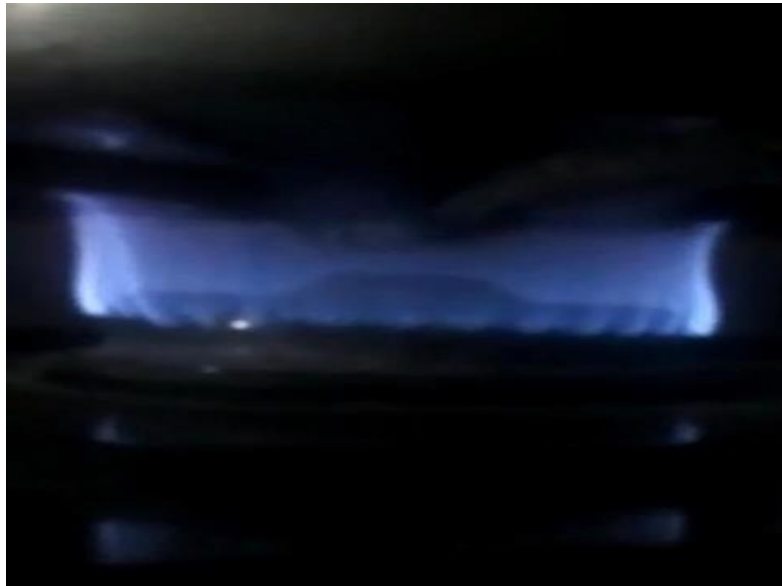
Ilustración 35 Tipo de llama del biogás producido
