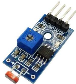
Ilustración 32 Sensor Intensidad de Luz LM393. Fuente: Elaboración propia.
