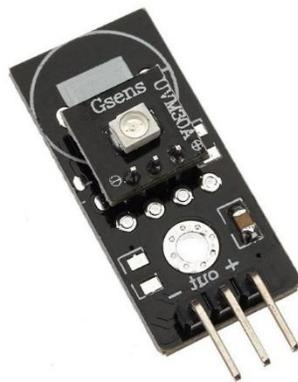
Ilustración 31 Sensor Ultravioleta UVM30A. Fuente: Elaboración propia.
