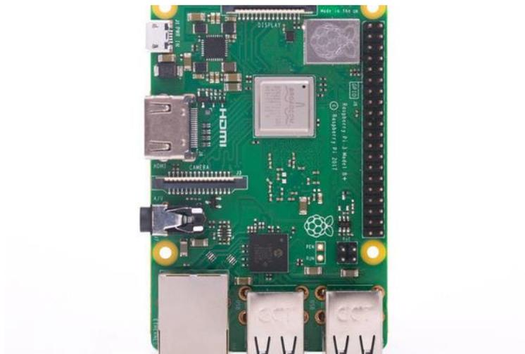
Ilustración 8. Raspberry Pi 3 Modelo B+, vista superior. Fuente: raspberrypi.org
