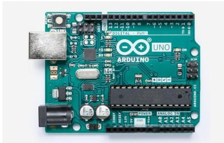
*Ilustración 10. Placa Arduino UNO Rev. 3. Fuente: arduino.cc*
