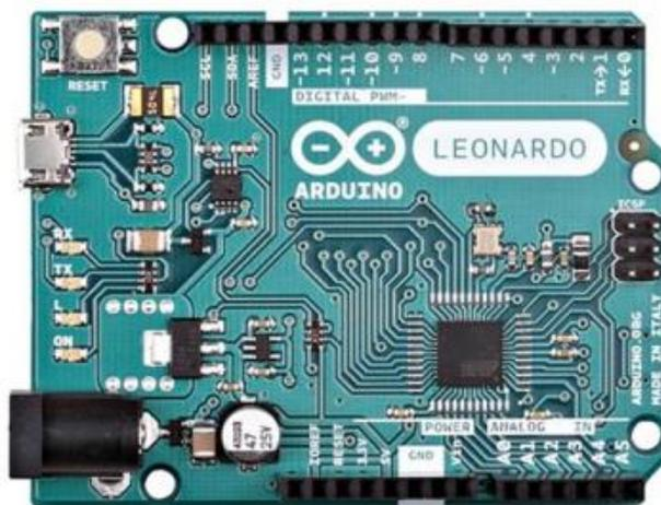
*Ilustración 11. Placa Arduino LEONARDO. Fuente: arduino.cc*
