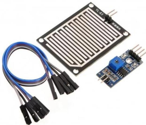
Ilustración 29 Sensor de lluvia YL-83. Fuente: Elaboración propia.
