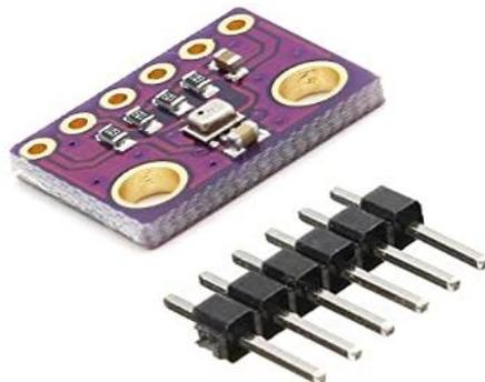
Ilustración 30 Sensor de Presión Barométrica BMP280. Fuente: Elaboración propia.
