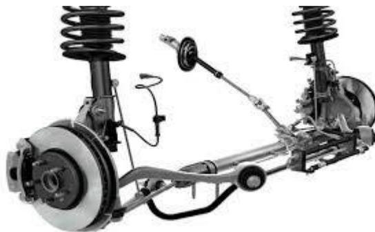
Ilustración 4. Suspensión semirrígida [13].
