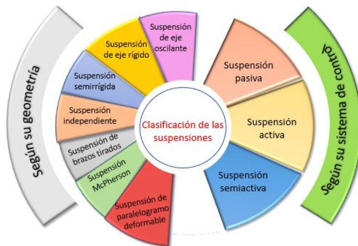
Ilustración 2. Clasificación de la suspensiones.
