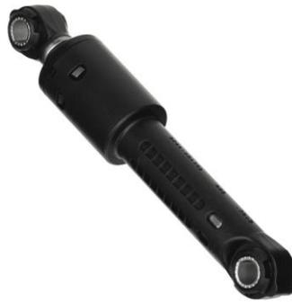
Ilustración 31. Amortiguador de fricción seca.
