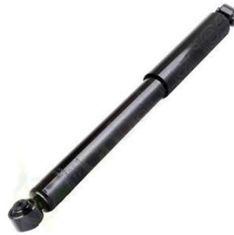
Ilustración 30. Amortiguador neumático.
