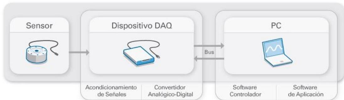
Ilustración 35. Comunicación DAQ [33].
