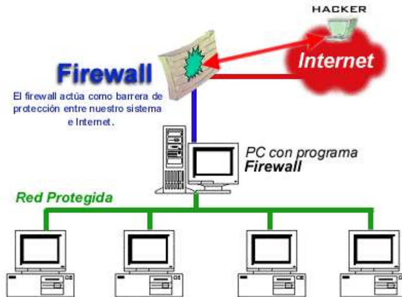
Figura 5. Ejemplo Clásico De Un Firewall En Una Red De Datos
