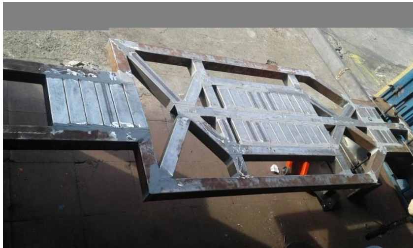
Figura 55. Chasis ensamblado y soldado
