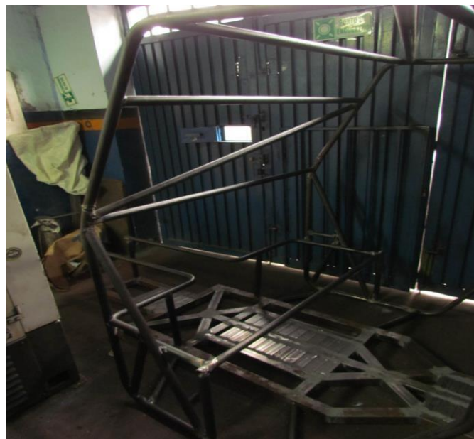
Figura 57. Carrocería fabricada y anclada al chasis con tolerancias respectivas
