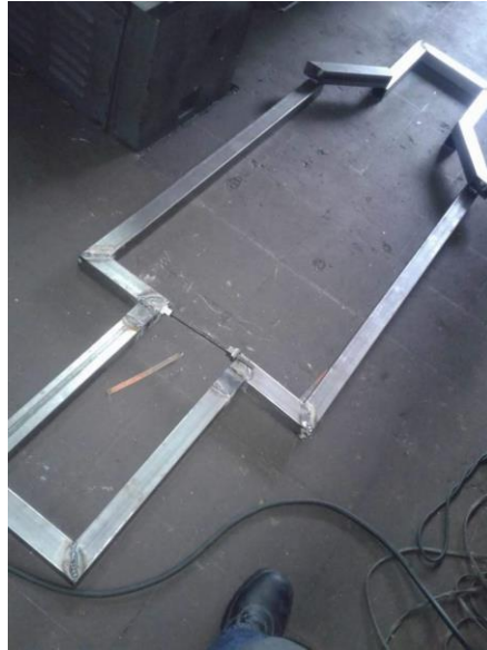
Figura 54. Proceso de ensamble y soldadura del chasis
