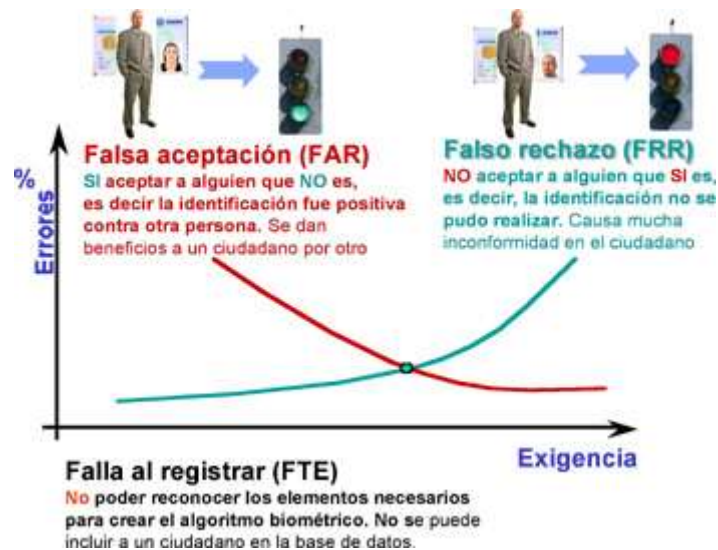
Figura No.10: Comparación entre el % de errores y el nivel de exigencia de los equipos
