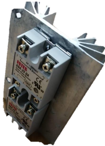
Ilustración 36 Disipación de calor en relés
