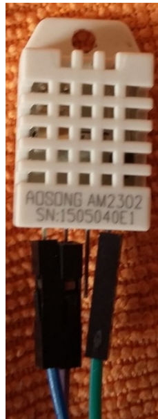
Figura 13. Sensor de humedad relativa y temperatura DHT22.
