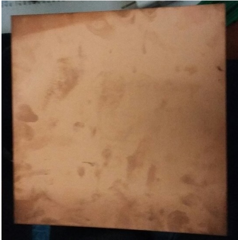
Figura 51. Baquelita de cobre usada para el diseño de circuitos electrónicos.
