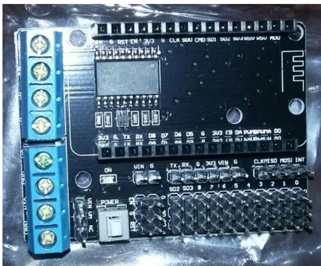
Figura 37. Motor Shield para tarjetas NodeMCU.
