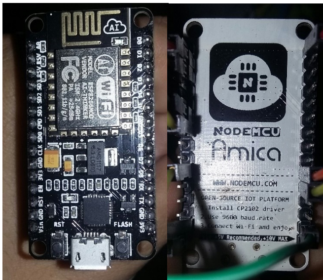
Figura 36. Vistas delantera y trasera de la tarjeta de desarrollo NodeMCU.
