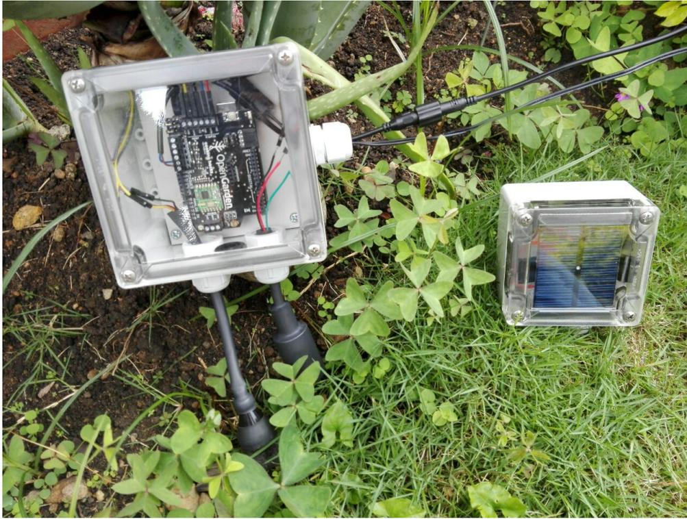
Figura 36: Despliegue del Sistema WSN en un ambiente controlado
